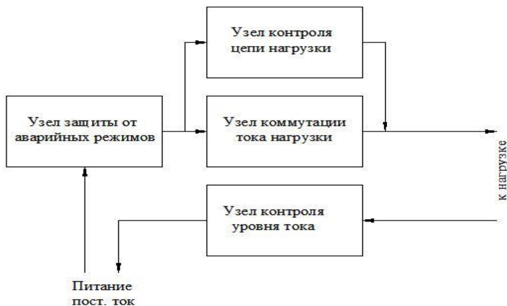
Рис. 1. Функциональная структура модуля контроля исполнительного механизма
